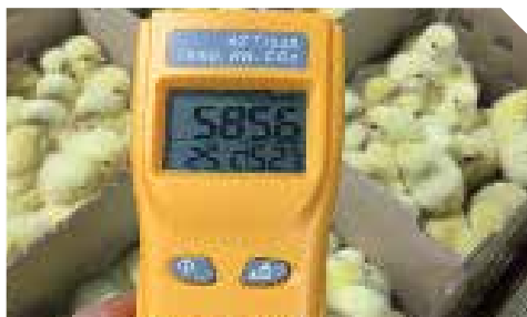
Рис. 1 Высокое содержание CO 2 в зале хранения по причине недостаточной вентиляции
