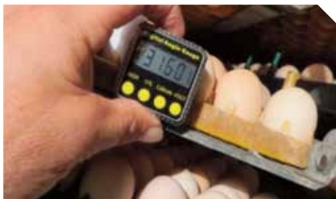
Рис. 1 Угол поворота 31.6° является недостаточным. Обеспечьте угол 40–45°
