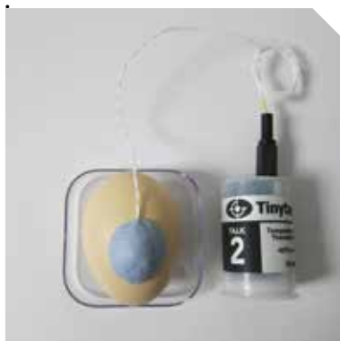
Рис. 1 Термисторный датчик TINYtag закреплен ниже экватора яйца с помощью кусочка пасты Blu-Tack
