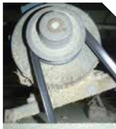
Рис. 2 Неправильное положение ремня на рабочем колесе (низко)
