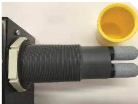
Рис. 1 Фото выше показывает типичные сенсоры CO 2 в инкубационном шкафу, защищенные колпачками. Колпачки могут засориться пылью или конденсатом, и сенсор будет показывать завышенное значение
