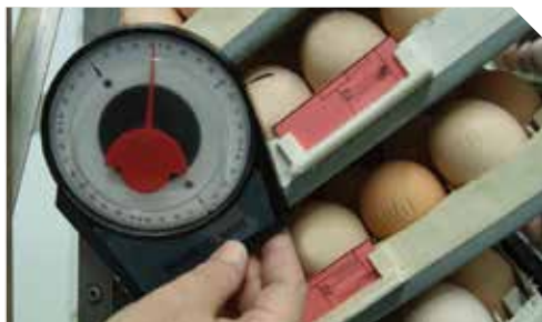
Рис. 2 Угол поворота 42° – оптимальный
