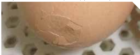
Рис. 2 Избыточное вакуумное давление подъемным устройством вызвало повреждение тупого конца яйца
