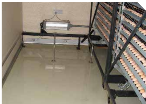
Рис. 1 Вода на полу одностадийного инкубатора в конце периода, когда инкубатор герметично закрыт
