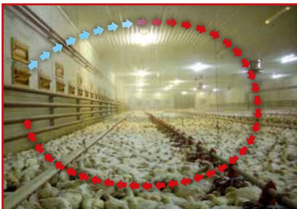
Дым сначала движется к потолку, затем по кругу опускается к полу.
